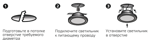
Рис. 2. Схема подключения светодиодного светильника к электросети 220 В
